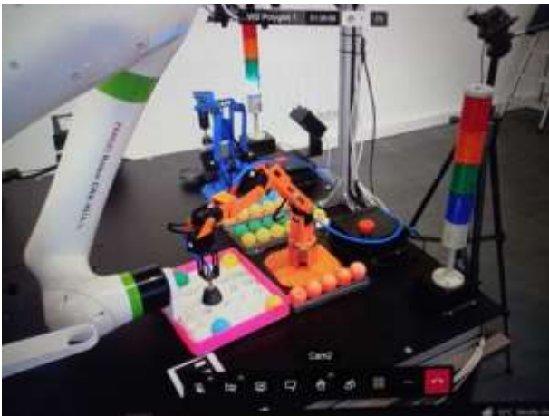
Рисунок 3. Робот-манипулятор укладывает на паллет 4 разноцветных шара (слева: синий, зеленый, два желтых) и отбирает шары оранжевого цвета для сброса.
